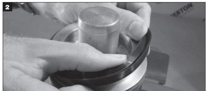
2 Den Kolben sicher halten, die Dichtung in die Nut einsetzen und beginnen, die Dichtung mit den Fingern über den Kolbenkopf zu dehnen.
